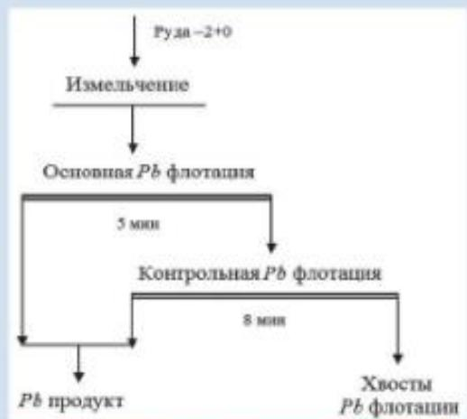
Рис. 1. Схема открытых опытов по отработке режима свинцового цинка.
