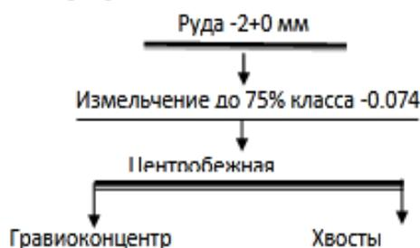
Рисунок 1 – Схема опытов по выделению гравитационного концентрата
